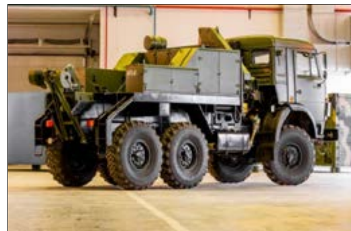
Camion lourd de dépannage 8X4 avec 2 treuils
